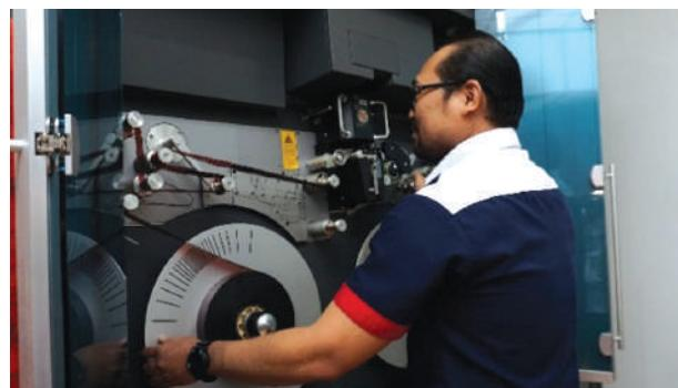
**Gambar 6 :** Aktiviti imbasan bahan audio visual menggunakan mesin *Scanity*
